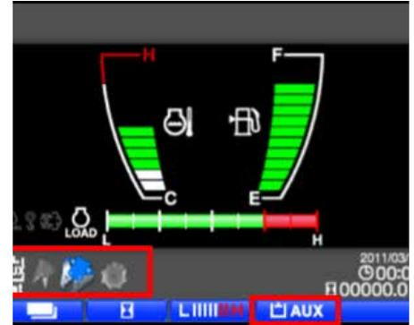
Le configurazioni memorizzate sono richiamabili rapidamente dal menu iniziale premendo il tasto AUX, lo strumento selezionato apparirà a colori. Selezionando il simbolo scelto, il sistema darà la portata di olio memorizzata.
