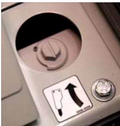
Rubinetti selettore impianto ausiliario doppio effetto (pinza) o singolo effetto (martello).
