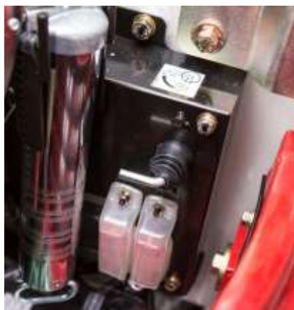
Staccabatteria nel vano motore.
