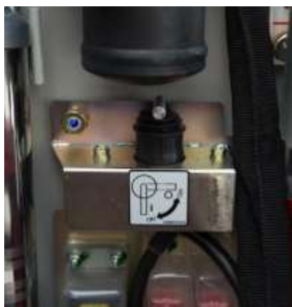
Staccabatteria nel vano motore.
