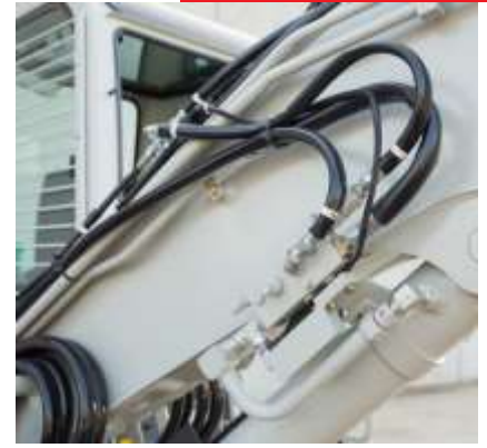
Valvole di sicurezza anticaduta su braccio e avambraccio con allarme di sollevamento, per la movimentazione dei carichi sospesi come da norma con riferimento sul certificato di omologazione della macchina.
