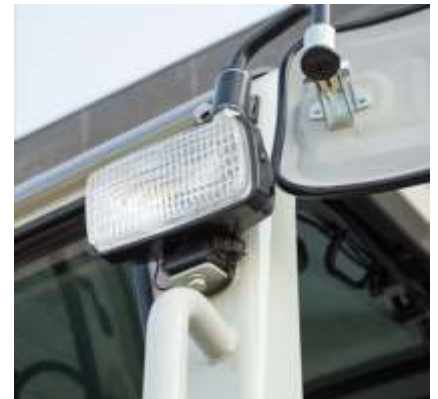
Fari di lavoro su braccio di sollevamento con protezione e sopra la cabina. Comando in cabina.
