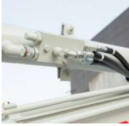
Valvole di sicurezza anticaduta su braccio e avambraccio con allarme di sollevamento, per la movimentazione dei carichi sospesi come da norma con riferimento sul certificato di omologazione della macchina.
