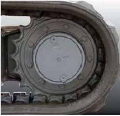
Motore di traslazione con inserimento automatico della marcia ridotta quando è richiesta forza per spingere o spianare.
